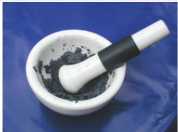
Figure 5 - Avec un mortier et un pilon, écrasez quelques journaux jusqu'à obtenir une pâte homogène dans laquelle les fibres sont isolées. Placez la pâte dans une cuvette remplie d'eau et mélangez à la main pour aider les fibres à se séparer les unes des autres.
