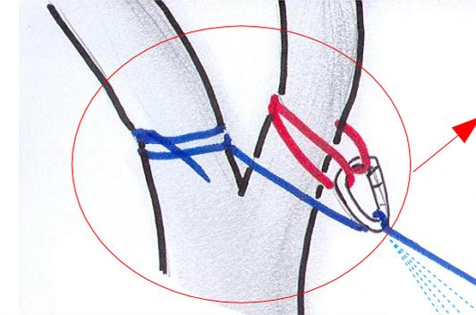
La réalisation débute par la mise en place d'un **amarrage solide** en haut de la tyrolienne (voir diapo 2).
